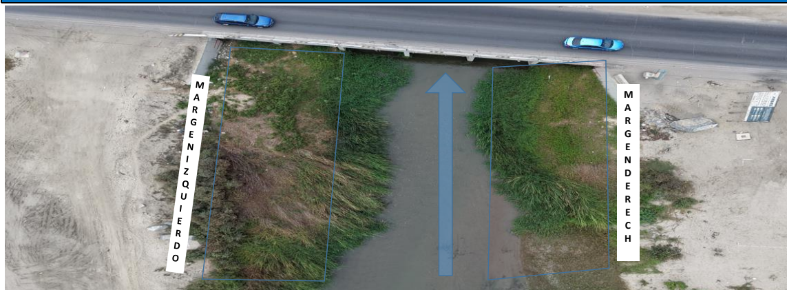
FIGURA N°01: Vista desde el dron Sobre el Puente Panamericana, se aprecia el cauce del río Lacramarca. La meta física consta de la descolmatación y conformación de dique con material propio en ambos márgenes del Río Lacramarca en una longitud total de 110 ml aproximadamente, dentro de los cuales se colocaran dique con enrocado, en ambas márgenes.
